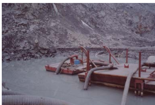
金堆城钼业公司露天矿 SQ220-50型75kW排沙潜水泵现场图片
